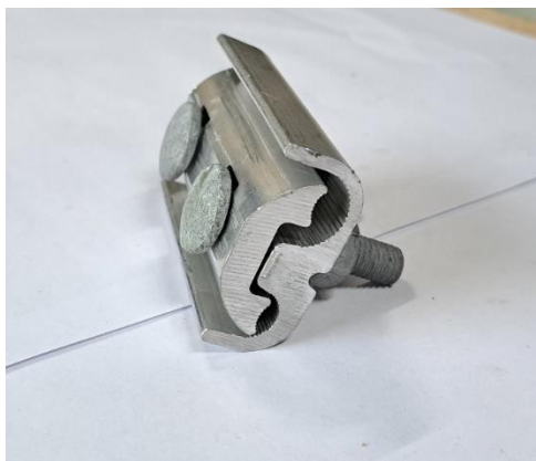
Figura 23 - Conector de Alumínio - 2 Parafusos - 1/0 a 4/0 AWG.
