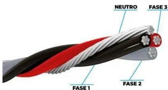
Figura 19 - Condutor Multiplexado Al. - XLPE - 0,6/1kV - Quadriplex 70mm 2 .
